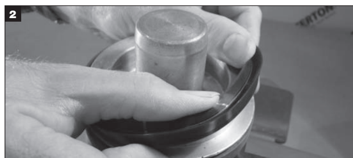
Tenere fisso il pistone, posizionare la tenuta nella sua sede e premere con le dita per iniziare ad allargarla sulla testa del pistone.
